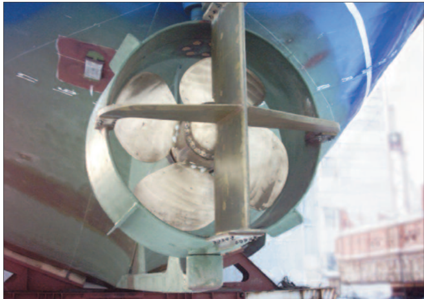
> ВРШ ВР1496М в поворотной насадке, установленный на корабле.
