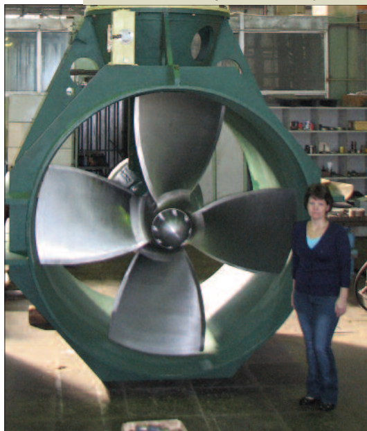
> Подруливающее устройство ПУ200Ф мощностью 1100 кВт.
