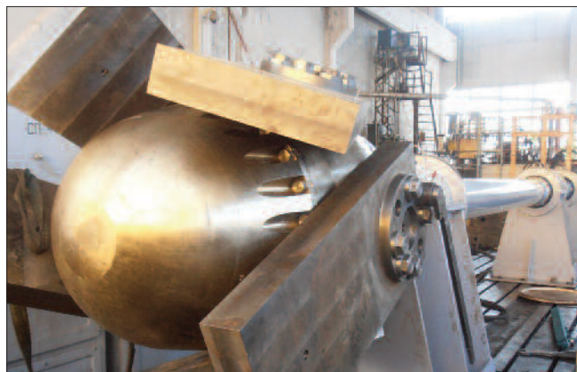
> ВРШ ПСКР проекта «Океан» на испытательном стенде опытного завода «Вега».
